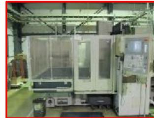
炭酸ガス二次元レーザー加工機
